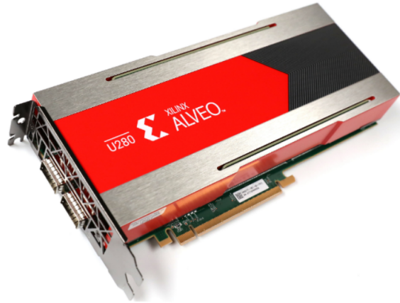
FIGURE 6.6 – Carte accélérateur pour centre de données, Alveo U280. La version 280P de la plate-forme ACP sera un modèle en pré-production
